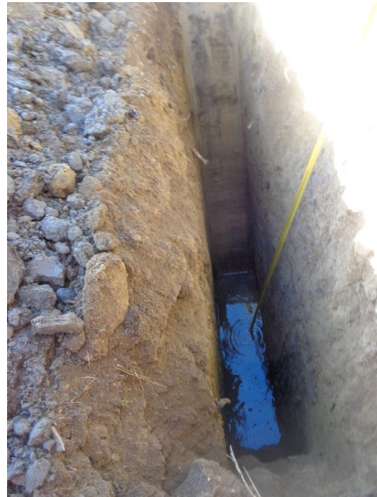
Foto 4: Schürfgrube Baggerschurf Nr. 5 bei ca. Km 53,5. / Trincea del saggio esplorativo n. 5 a ca. Km 54.
